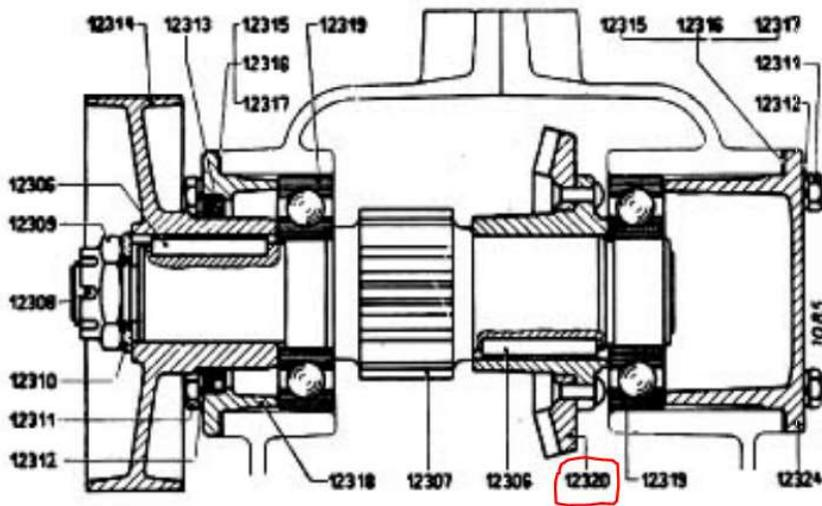
Der Unterschied vom F2L612/5-NK zum /5-HK sollte einzig und allein in der Kegelradwelle und dem zugehörigen Kegelrad der Zwischenwelle zu finden sein. Hier gibt es zwei unterschiedliche Positionen:
